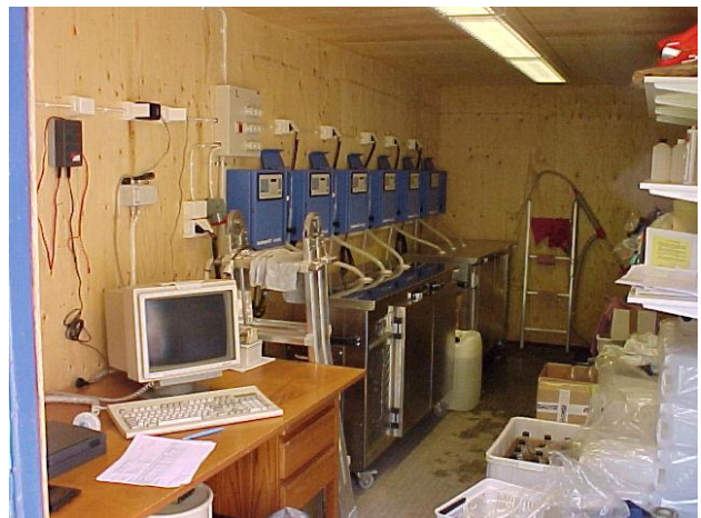
Bild 7.3 Flödesmätarutrustning samt vattenprovtagare i provtagningsanläggningen.
