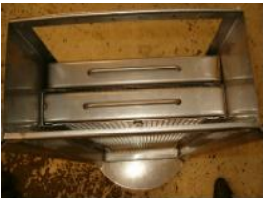
Bild 5.4 SorbClean består av en ram och två filterkassetter.
