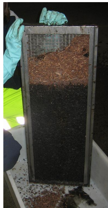
Bild 5.8. SorbClean filterkassetten som ska tömmas på absorberent.
