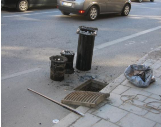
Bild 5.3 Ett Innoletfilter som plockats upp ur en dagvattenbrunn efter försöksperioden.
