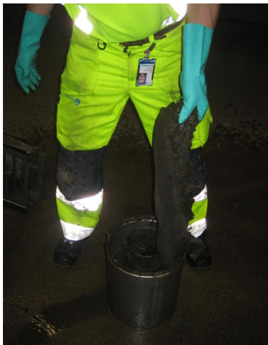
Bild 9.16 Mycket föroreningar hamnade på utsidan av filterkorven istället för i filtrermassan.
