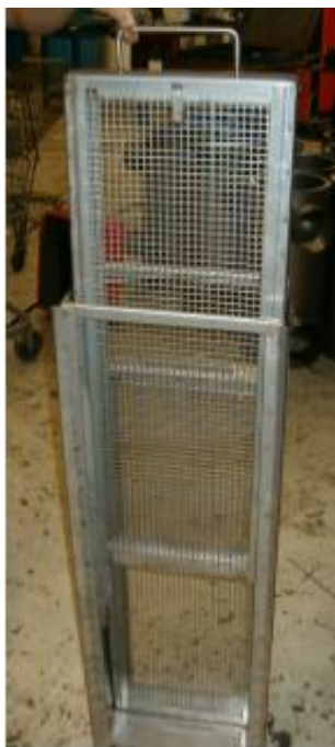
Bild 5.6 Filtermaterialet kan bytas ut genom byte av filterkassetterna medan ramen sitter kvar.
